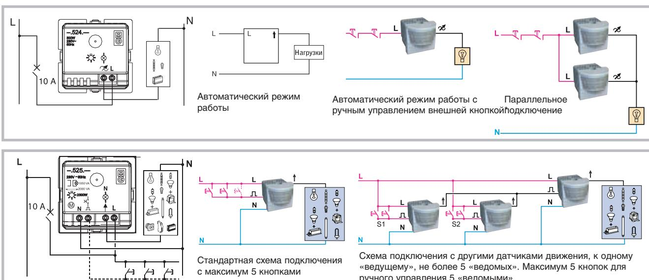
\* Последовательно подключается не более 5 кнопок. Кнопки с «нормально-открытыми» контактами.
